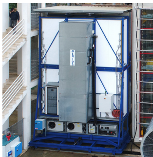
Camera termica realizzata per il Building Future Lab
