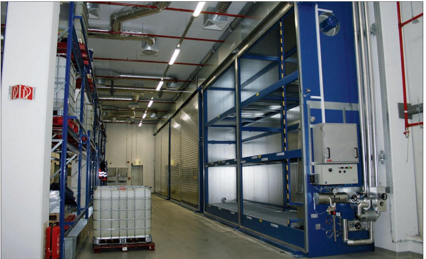
Camera termica WK 714-3 con tre livelli di stoccaggio e porta a serranda avvolgibile per riscaldare a 50 °C esaltatori di sapidità nell'industria alimentare. Rivestimento interno zincato. Antideflagranza interna ed esterna. Controllo della temperatura mediante riscaldamento a vapore.
