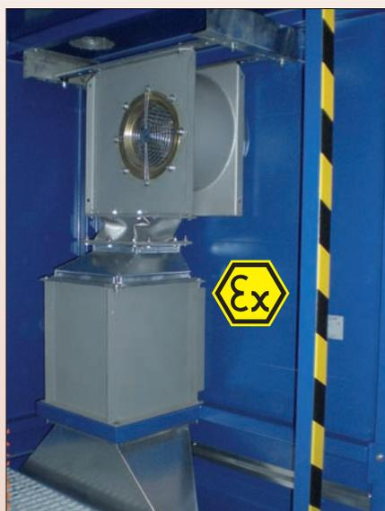
Riscaldatore interno con ventilatore di ricircolo, condotto di scarico dell'aria, tutto in versione antideflagrante
