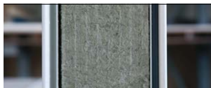
Vista del pannello in lana minerale con i bordi di giunzione per il pannello successivo
